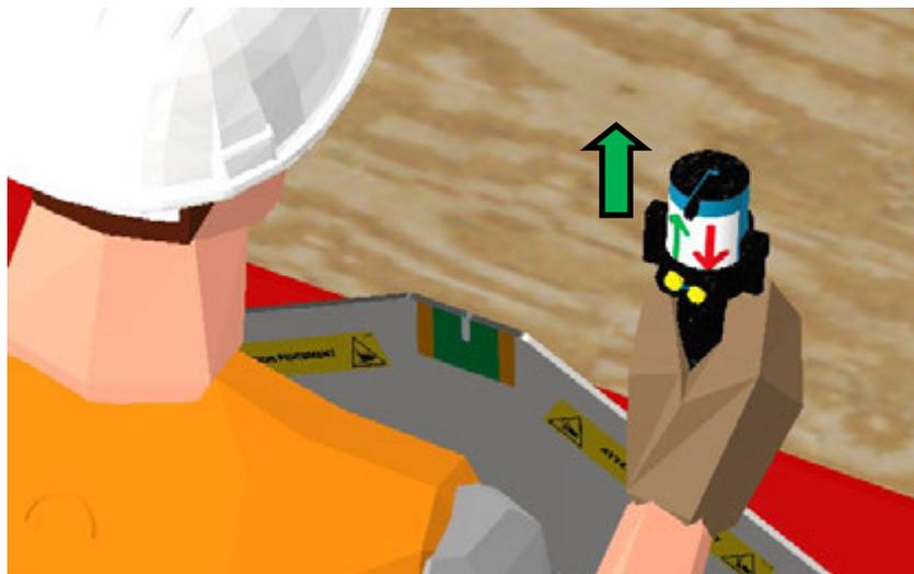
Une fois le panneau en butée et centré sur le chariot, actionner la montée du vérin en appuyant sur le bouton dédié (cf. partie « commander le vérin »).
