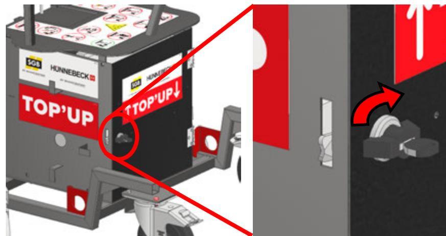
Tourner d'un quart de tour le loquet à came pour déverrouiller la porte. Ouvrir la porte du carter pour accéder au compresseur.
