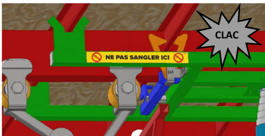
Le plateau vient alors en contact avec le panneau jusqu'à entendre un « Clac », validant le **bon verrouillage** du panneau avec le plateau.
